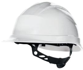
Bauhelm aus hoch-widerstandsfähigem Polypropylen (PP) mit Anti-UV-Behandlung. Polyamid-Innenausstattung: 3 Textilbänder mit 8 Befestigungspunkten. Frottee Schweißband. System zum Festziehen Rotor: Kopfumfang von 53 bis 63 cm. 2 Positionen der Innenausstattung möglich (hoch/niedrig) für besseren Tragekomfort. Elektrische Isolierung bis AC 1000 V oder DC 1500 V.
