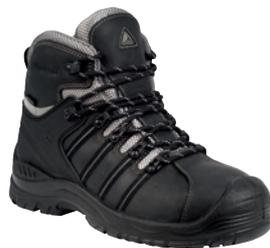
Schaft: Volleder, S3 wasserdicht. Futter: DELTA-TEX™ wasserfest Membrane aus Polyester. Innensohle: Auswechselbar - Oberseite Polyester mit EVA. Sohle: Eingespritzt - Dual-Density-PU. PU-Überkappe. Nicht magnetischer Sicherheitsschuh.
