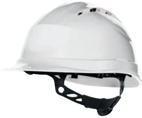
Bauhelm aus hoch-widerstandsfähigem Polypropylen (PP) mit Anti-UV-Behandlung. Polyamid-Innenausstattung: 3 Textilbänder mit 8 Befestigungspunkten. Frottee-Schweißband. System zum Festziehen Rotor : Kopfumfang von 53 bis 63 cm. 2 Positionen der Innenausstattung möglich (hoch/niedrig) für besseren Tragekomfort.
