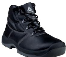
Schaft: Narbenleder, S3 wasserfest. Futter: Mesh und Polyamid. Innensohle: Auswechselbar vorgeformt - Oberseite Polyester mit EVA. Sohle: Injiziertes 2-Dichten-PU.
