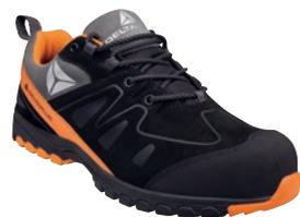
Schaft: Veloursspaltleder (Rind), S3 wasserdicht, mit Gummi-Überkappe vorne. Futter: Fleece und Polyester-Mesh. Innensohle: Auswechselbar vorgeformt - Oberseite Polyester mit EVA. Sohle: vulkanisiert - Phylon. Trageunterschicht: Gummi. Nicht magnetischer Sicherheitsschuh.
