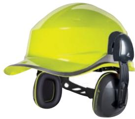
Kapselgehörschutz für Bauhelm, in Höhe anpassbar. Bügel und Schalen aus hochflexiblem ABS. Kapsel gepolstert mit Synthetikschaum. Zu verwenden direkt auf dem Bauhelm oder mit Visierhalterung VISOR HOLDER. Passend für Bauhelme GRANITE, SUPER QUARTZ, QUARTZ, ZIRCON und BASEBALL DIAMOND.
