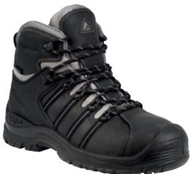
Schaft: Voller, S3 wasserdicht. Futter: DELTA-TEX™ wasserfest Membrane aus Polyester. Innensohle: Auswechselbar - Oberseite Polyester mit EVA. Sohle: Eingespritzt - Dual-Density-PU. PU-Überkappe. Nicht magnetischer Sicherheitsschuh.
