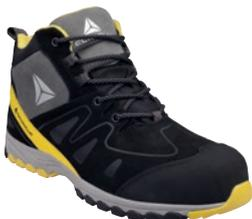
Schaft: Velourspaltleder (Rind), S3 wasserdicht, mit Gummi-Überkappe vorne. Futter: Fleece und Polyester-Mesh. Innensohle: Auswechselbar vorgeformt - Oberseite Polyester mit EVA. Sohle: vulkanisiert - Phylon. Trageunterschicht: Gummi. Nicht magnetischer Sicherheitsschuh.
