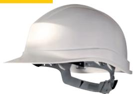
Elmetto da cantiere polipropilene (PP) o polietilene alta densità (HDPE), trattato anti-UV. Cuffia polietilene (LDPE), con 8 punti di fissaggio. Frontalino spugna. Chiusura a fibbia regolabile: girotesta da 53 a 63 cm. Elmetto dielettrico (isolamento fino a 1000 VAC o 1500 VCC). Foro standard per accessori. Punti di ancoraggio per sottogola a 2 o a 4 punti.
