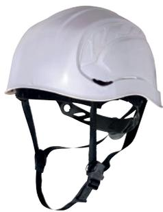
Elmetto da cantiere in ABS. Stile caschi alpinismo: senza frontino, per una migliore visione verticale. Ingombro minimo. Leggero. Cuffia poliamide: 3 fasce tessili con 8 punti di fissaggio. Frontalino antisudore termoformato. Sistema di chiusura ROTOR, regolabile: giro-testa da 53 a 63 cm. Venduto con sottogola a 3 punti di ancoraggio. Specifico per i lavori in altezza. Elmetto dielettrico (isolamento fino a 1000 VAC o 1500 VDC).
