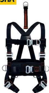
Imbracatura con cintura. 2 punti di ancoraggio anticaduta (dorsale - sternale). 6 fibbie di regolazione di cui 4 automatiche. Cintura di posizionamento con schienale termoformato. 2 punti di ancoraggio per mantenimento della posizione (laterali). 1 cinghia di prolunga.
