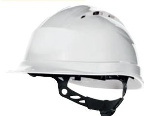
Elmetto da cantiere ventilato, polipropilene (PP) alta resistenza trattato anti-UV. Calotta poliammide : 3 Fasce tessili con 8 punti di fissaggio. Frontalino spugna. Sistema di chiusura Rotor : giro-testa da 53 a 63 cm. 2 posizioni possibili del girotesta (alto/basso) per un miglior comfort.
