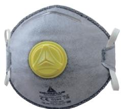
Scatola da 10 mascherine filtranti FFP2 in fibra sintetica non tessuto impregnata di carbone attivo. Protezione contro gli odori dannosi (ad esempio fumo di zolfo). Preformate. Stringinaso regolabile. Rinforzo bordo in spugna sotto lo stringinaso. Valvola d'espirazione altamente performante. Test opzionale DOLOMIA per un comfort respiratorio prolungato.
