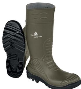
Tomaia: PVC. Fodera: Poliestere. Protezione dei malleoli. Paraurti di protezione anteriori e posteriori. Aletta di rilascio. Puntaie: acciaio inossidabile. Suola antiperforazione: acciaio inossidabile. Suola: PVC - Nitrile.
