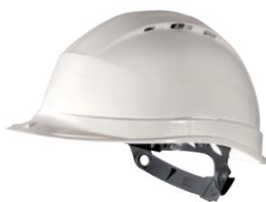
Elmetto da cantiere ventilato, polipropilene (PP) alta resistenza trattato anti-UV. Calotta polietilene BD a stella con 8 punti di fissaggio. Frontalino spugna. Chiusura a fibbia regolabile : Girotesta da 53 a 63 cm. 2 posizioni possibili del girotesta (alto/basso) per un miglior comfort. Elmetto ventilato con aerazione regolabile.
