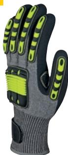
Supporto in polietilene ad alte prestazioni. Rinforzo dietro e sulla punta delle dita in TPR. Doppio rivestimento nitrile liscio/schiuma di nitrile sul palmo e la punta delle dita. Rinforzo in rilievo all'interno del palmo. Fodera interna in acrilico. Filo di Kevlar® su tutte le cuciture.
