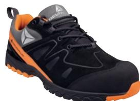
Tomaia : pelle scamosciata (vacchetta), impermeabilizzata S3 con rinforzi davanti in gomma. Fodera: non tessuto e mesh in poliestere. Soletta di pulizia : Staccabile preformata - Sopra poliestere su EVA. Suola : Saldata - Phylon. Strato d'usura : Caucciù nitrile. Scarpa amagnetica.
