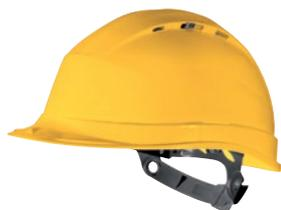
Elmetto da cantiere ventilato, polipropilene (PP) alta resistenza trattato anti-UV. Calotta polietilene BD a stella con 8 punti di fissaggio. Frontalino spugna. Chiusura a fibbia regolabile - Girotesta da 53 a 63 cm. 2 posizioni possibili del girotesta (alto/basso) per un miglior comfort. Elmetto ventilato con aerazione regolabile.
