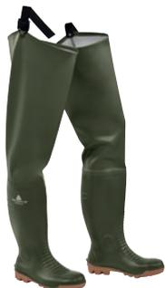
Tela rivestita: PVC, altezza: 80 cm. Saldatura a caldo ad alta frequenza impermeabile al 100%. Fodera: cotone jersey. Cinghie di sostegno in nylon. Protezione dei malleoli. Aletta di rilascio. Puntalet: acciaio inossidabile. Suola antiperforazione: acciaio inossidabile. Suola: PVC - Nitrile con grande carroarmato.
