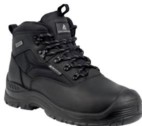
Tomaia: Pelle pieno fiore, trattamento impermeabilizzante S3. Fodera : membrana poliestere impermeabile DELTA-TEX™. Soletta di pulizia : Staccabile preformata - Sopra poliestere su EVA. Suola : Iniettata - PU doppia densità. Para colpi di protezione in PU.
