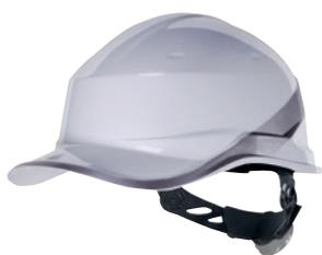
Elmetto da cantiere ABS. Innovativa forma stile cappellino da baseball, che consente una maggiore visione in verticale. Testato con il frontino indossato in avanti, ma anche indietro, per avere meno ingombro. Cuffia poliamide: 3 fasce tessili con 8 punti di fissaggio. Sistema di chiusura Rotor: girotesta da 53 a 63 cm. 2 posizioni possibili del girotesta (alto/basso) per un miglior comfort. Elmetto dielettrico (isolamento fino a 1000 VAC o 1500 VCC).
