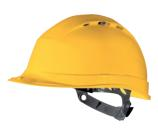
Capacete de estaleiro ventilado em polipropileno (PP) alta resistência tratamento anti-UV. Coifa polietileno BD em estrela com 8 pontos de fixação. Banda de suor em esponja, Aperto deslizante ajustável: perímetro da cabeça de 53 a 63 cm. 2 posições possiveis de perimetro da cabeça (alta / baixa) para um maior conforto. Capacete ventilado com ventilação ajustável.
