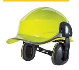
Conchas anti-ruído para capacete de estaleiro reguláveis em altura. Braço e conchas ABS alta flexibilidade. Conchas envoltas em mousse sintética. A utilizar directamente sobre o capacete ou com o porta-viseira VISOR HOLDER. Adaptável sobre os capacetes GRANITE, SUPER QUARTZ, QUARTZ, ZIRCON e BASEBALL DIAMOND.
