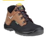
Calçado: Couro, S3 tratamento "waterproof" e exterior em couro impregnado com PÚ. Forro: Malha 3D absorvente. Palmilha de higiene: Amovível preformada - Por baixo poliéster sobre EVA. Palmilha : Injectada - PU bi-densidade.
