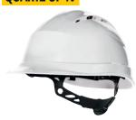
Capacete de estaleiro ventilado em polipropileno (PP) alta resistência tratamento anti-UV. Coifa poliamida : 3 Bandas têxteis com 8 pontos de fixação, banda de suor em esponja. Sistema de aperto Rotor: perímetro da cabeça de 53 a 63 cm. 2 posições possíveis do perímetro da cabeça (alta / baixa) para um maior conforto.
